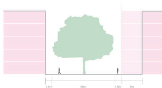
Principe doorsnede Ring met margestroken en rooilijn bij positie van bomen
